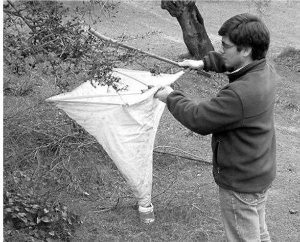
**Fig. 4** – Dispositivo para a recolha de artrópodes após as pancadas nos ramos das oliveiras.
