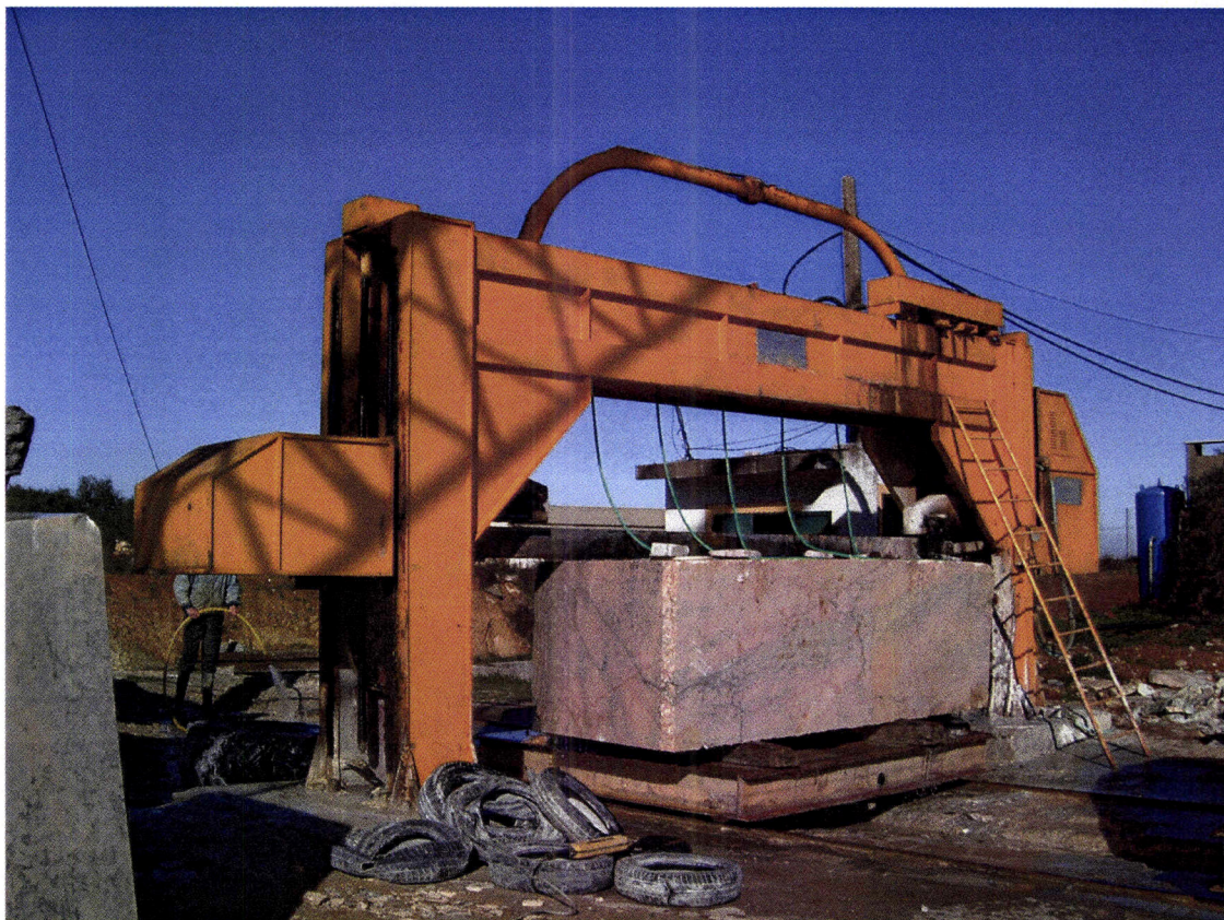
Figura 13.IV - À boca da pedreira o corte na monolâmina é dos trabalhos que mais água utiliza – fotografia Luis Lopes, UEv.
