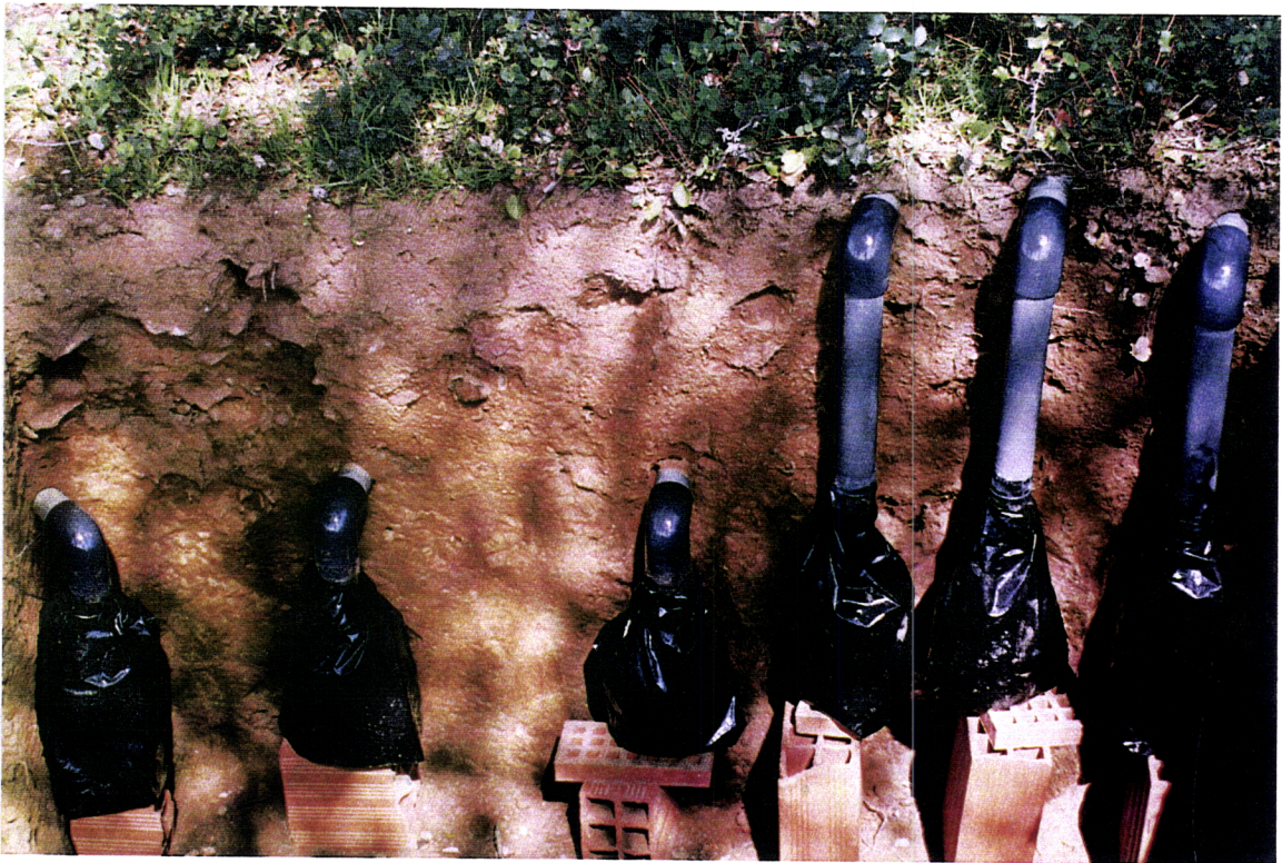
Figura 2.7. – Aspecto parcial da parcela II, com destaque para os dispositivos de recolha de solução de solo por gravidade.
