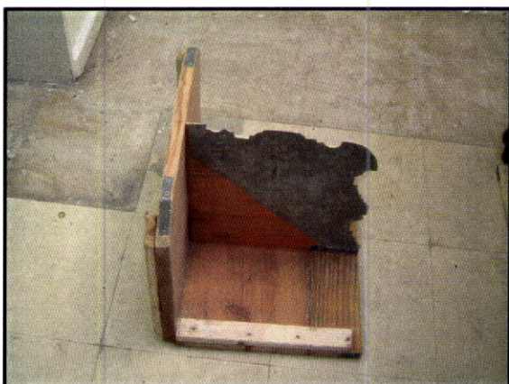
Figs. 365 e 366 – Oficina Ramos Meira. Espólio da Câmara Municipal do Porto. Moldes ou cêrceas para correr molduras de perfis diversos. Os perfis são em chapa de zinco, por esta se revelar mais resistente à oxidação provocada pelo gesso.
