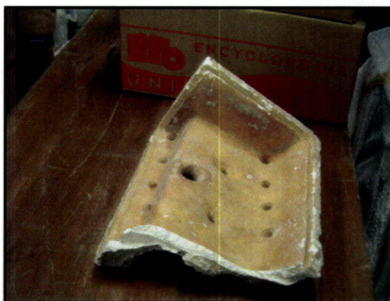
Fig. 370 – Oficina Ramos Meira. Molde com "gitos", orifícios destinados à saída do ar ao vazar a gelatina.
