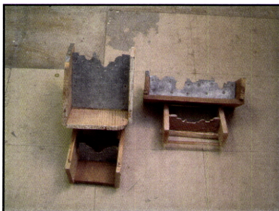
Figs. 365 e 366 – Oficina Ramos Meira. Espólio da Câmara Municipal do Porto. Moldes ou cêrceas para correr molduras de perfis diversos. Os perfis são em chapa de zinco, por esta se revelar mais resistente à oxidação provocada pelo gesso.
