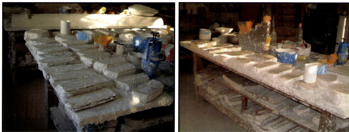
Fig. 3 e 4 – Oficina de Domingos Fontainhas. Observa-se o trabalho de fabrico dos ornatos de menores dimensões em moldes individuais. São visíveis copos cheios de filamentos de vassouras plásticas. Estes filamentos vieram substituir as fibras de piaçaba, normalmente utilizadas no reforço das peças mais frágeis. Estes filamentos são integrados no gesso conferindo maior solidez às peças. Uma das grandes vantagens da sua utilização reside de facto não colorir o gesso, ao contrário do que acontecia com o piaçaba que o amarelecia.
