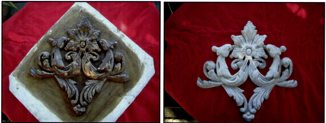
Fig. 3 e 4 - Modelo original esculpido sobre o qual já foi feito o molde de cera, e respectiva réplica.
