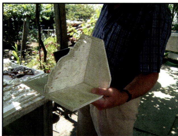
Figura 11 – Molde em madeira com recorte em folha de flandres para correr a moldura.
