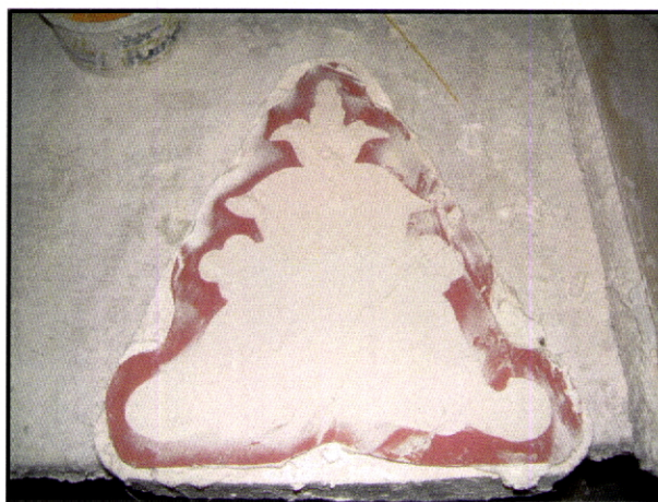
Fig. 3 e 4 – Oficina de Domingos Fontainhas. Observa-se o trabalho de fabrico dos ornatos de menores dimensões em moldes individuais. São visíveis copos cheios de filamentos de vassouras plásticas. Estes filamentos vieram substituir as fibras de piaçaba, normalmente utilizadas no reforço das peças mais frágeis. Estes filamentos são integrados no gesso conferindo maior solidez às peças. Uma das grandes vantagens da sua utilização reside de facto não colorir o gesso, ao contrário do que acontecia com o piaçaba que o amarelecia.
