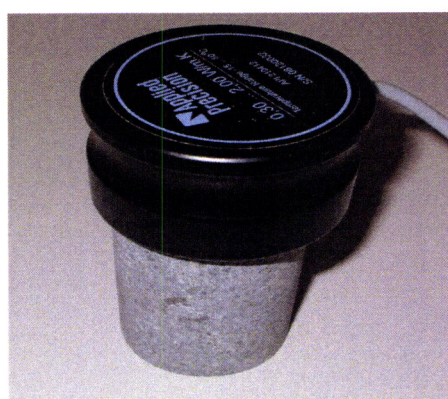
Figura 16: Fotografia da sonda sobre testemunho para efeito de determinação da condutividade térmica.
