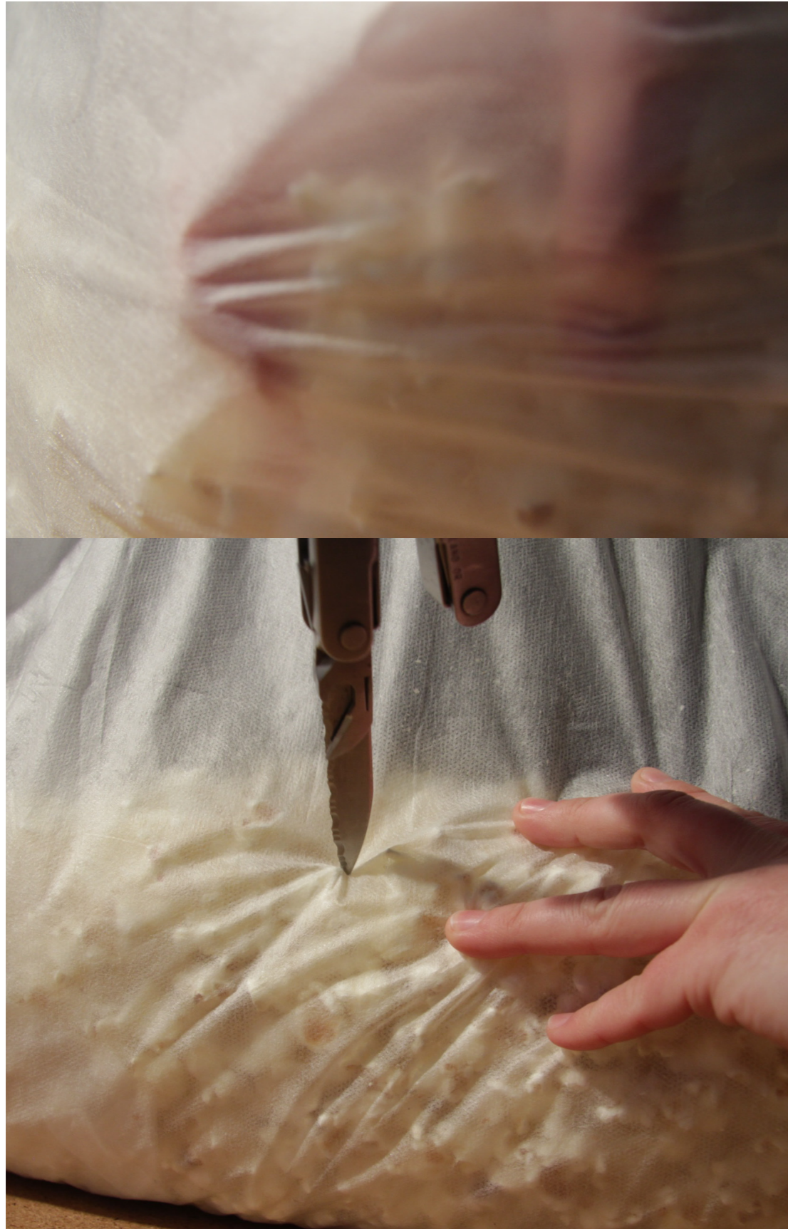
FIGURA 46: Testes de transparência e resistência do material de substituição © Ana Contente, 2014
