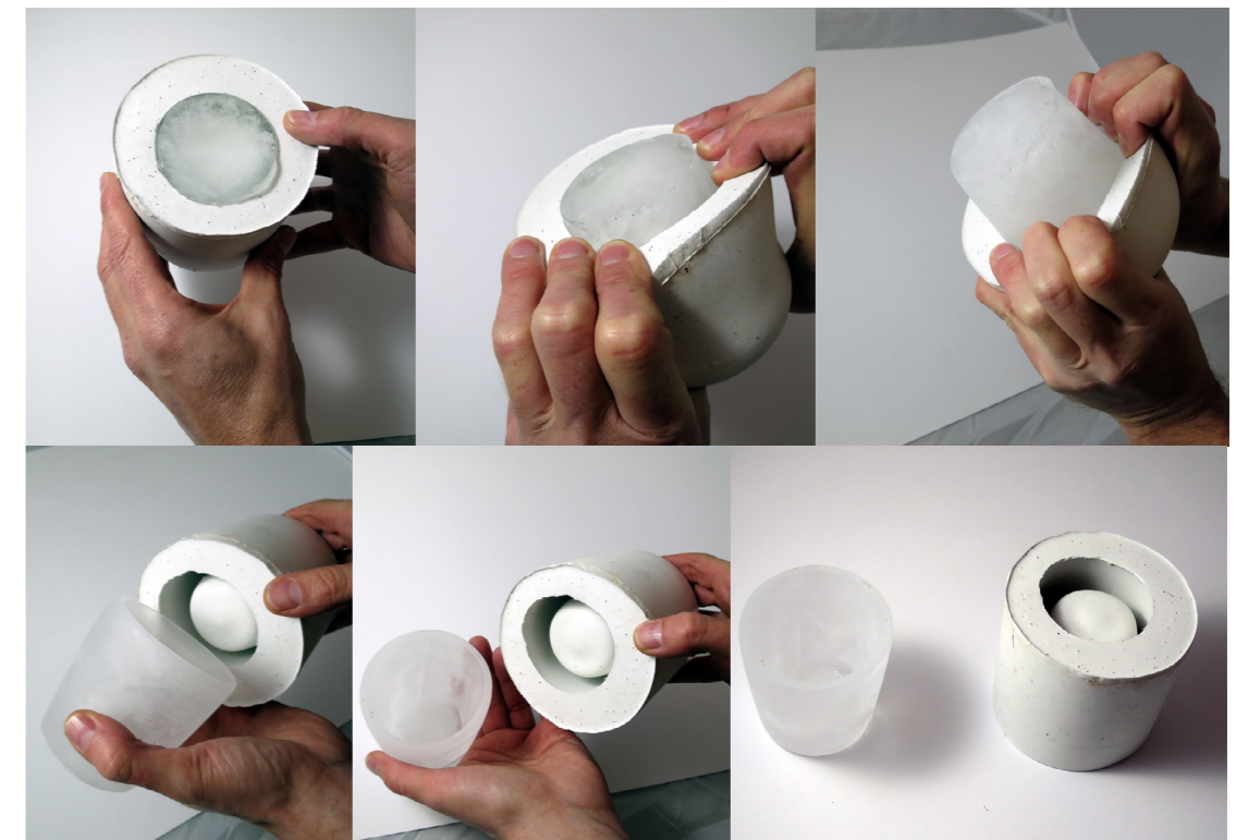
FIGURA 27: Desmoldagem de copo © Ana Contente, 2013
