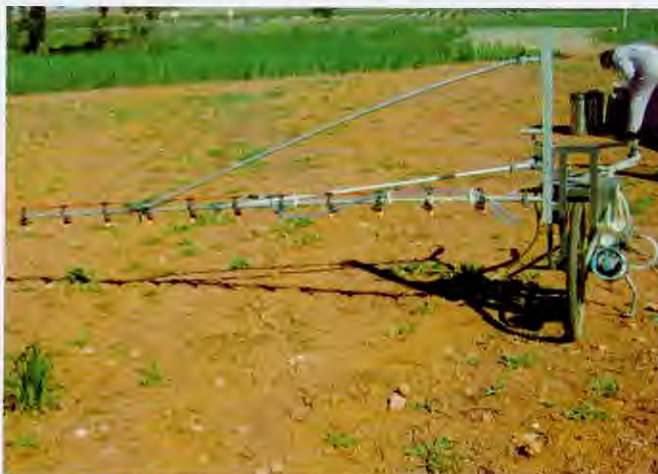
Fig. 2. Pulverizador de pressão de jato projetado utilizado no ensaio
