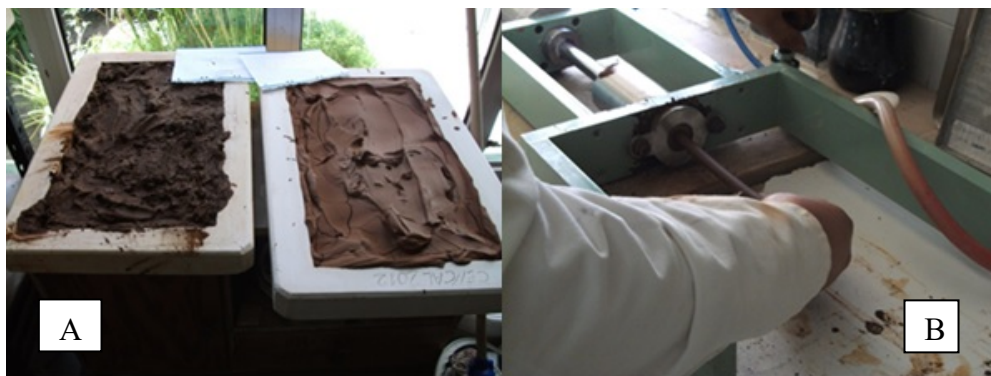
Fig. 3 – (A) Secagem em placa de gesso; (B) Conformação de provetes através de extrusão.
