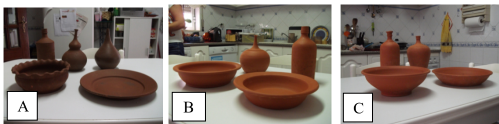
Fig. 7 – Aspectos cromáticos das matérias-primas após cozedura: A – Biblio VV; B – Borba VV; C – Lagoa.
