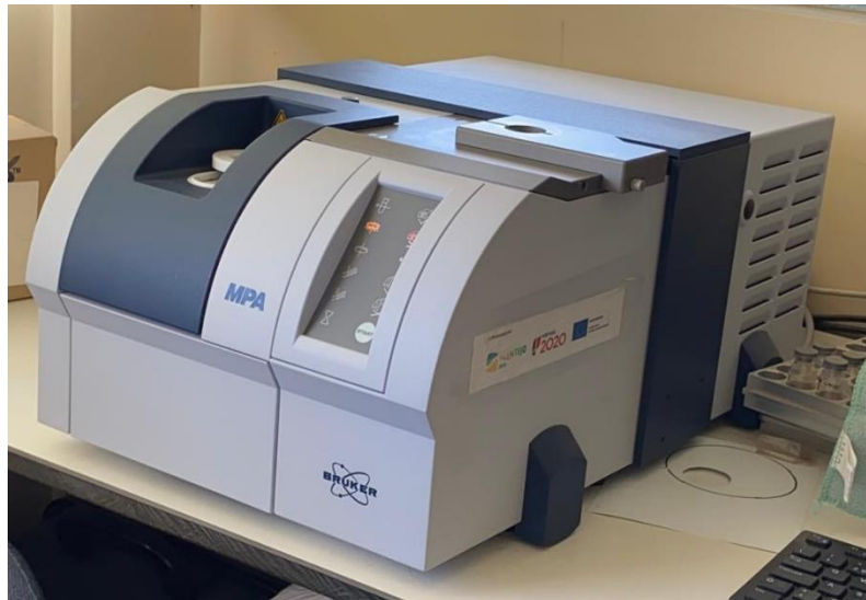
Figura 13 - Equipamento espectrômetro NIR com Transformada de Fourier modelo MPA – Bruker Optik GmbH, Germany .
