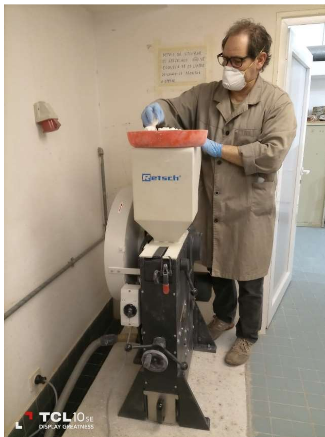
Fig. 14 – Moinho de maxilas e processo de desagregação das amostras.
