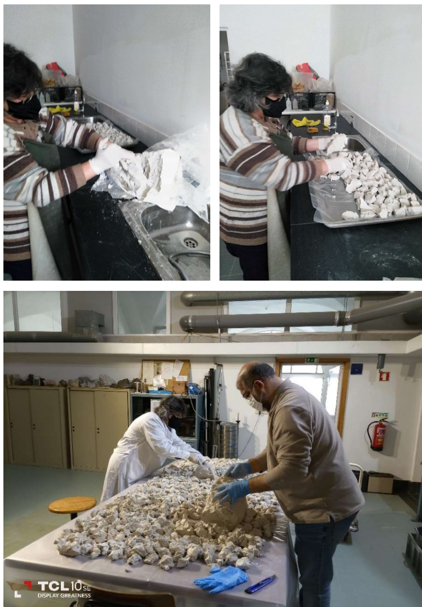
Fig. 12 – Corte de pedaços de pasta de nata e seu espalhamento para promover a secagem mais rápida à temperatura ambiente.
