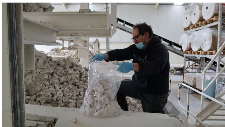
Fig. 3 – Imagem colhida na Solancis, mostrando a recolha da amostra à saída do filtro-prensa
