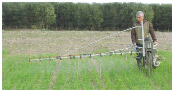
Fig. 2. Pulverizador de jato projetado para ensaios
