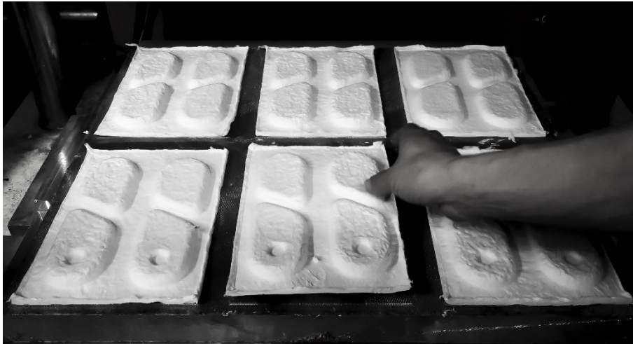
Figura 62 – Processo de moldagem/prensagem de componentes do ambientador Olite
