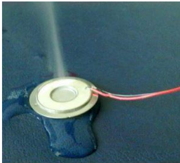
Figura 126 – Motor piezoelétrico a vaporizar ou nebulizar um líquido
