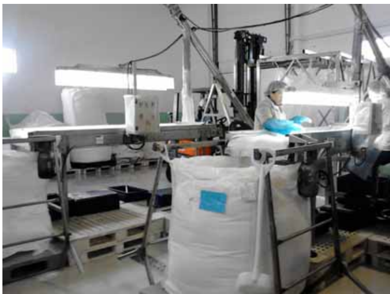
Figura 3 – Processo de Extração de Impurezas da Flor de Sal
