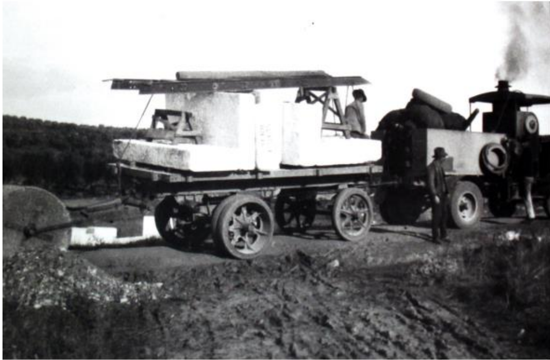
Figure 27 : Tracteur à vapeur avec remorque (source : QUINTAS, Armando. « Técnicas e tecnologias ligadas ao mármore: uma viagem pela história », p. 147, fig. 13)
