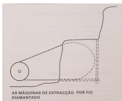
Figure 32 : Schéma du fonctionnement du sciage par fil diamanté (source : revue A Pedra, N°5, année II, juillet-septembre, 1981, p.51)
