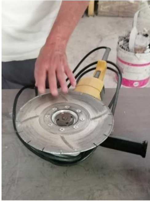
Figure 41 : Outil mécanique pour la sculpture du marbre (source : Julie Prévost, photo personnelle, octobre 2022)
