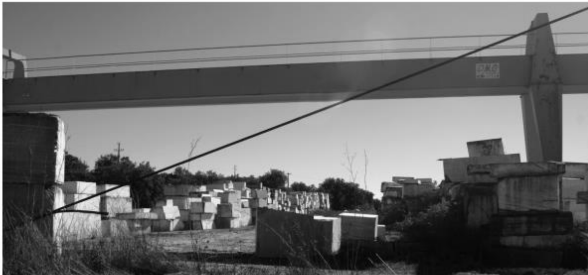
Figure 26 : Portique DMC dans une carrière de Vila Viçosa (source : QUINTAS, Armando. « Técnicas e tecnologias ligadas ao mármore: uma viagem pela história », p. 156, fig. 19)
