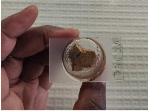
Fig. 063. Preparação das amostras para lâmina delgada.
