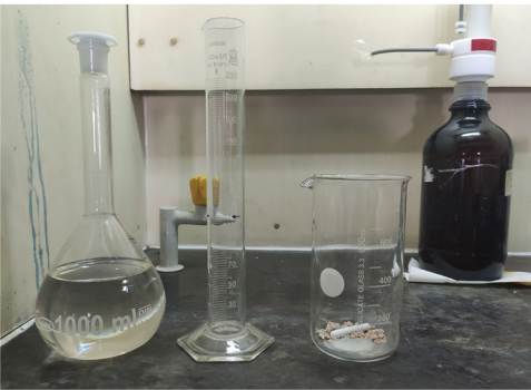
Fig. 070. Preparação da análise por ataque ácido: amostra e solução aquosa de ácido clorídrico.
