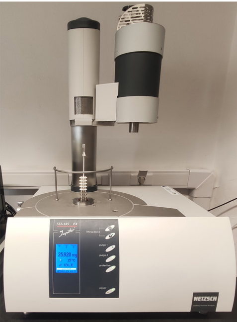
Fig. 068. Analisador Térmico Simultâneo STA 449 F3 Júpiter NETZSCH.
