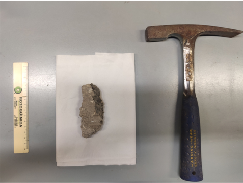
Fig. 064. Desagregação manual da amostra com a ajuda de um martelo.
