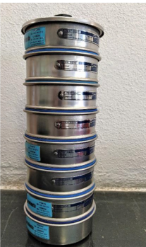
Fig. 073. Peneiras de teste ASTM E11 para análise granulométrica.
