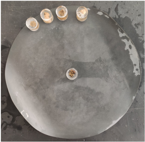
Fig. 062. Desgaste/Polimento manual das secções transversais em papel de carboneto de silício.
