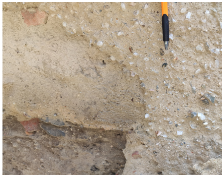
Fig. 050. Agregados com aproximadamente 30mm. Local de recolha da amostra ALC10R/T.
