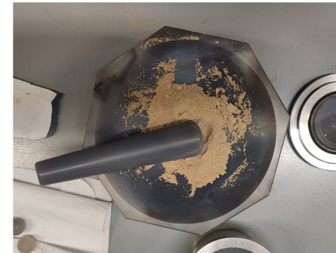
Fig. 058. Desagregação por pilão em almofariz de ágata.
