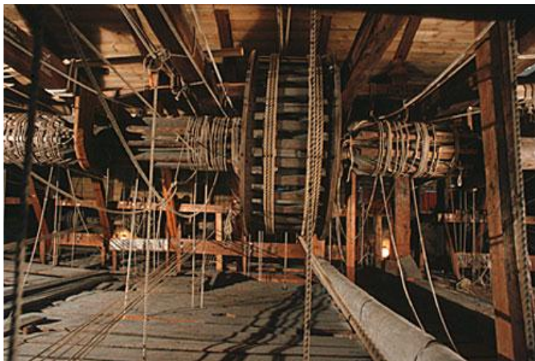
Fig. 310 – Tambor e maquinaria que permite mudanças de cena, bem como o controle dos mecanismos aéreos. Teatro do castelo de Cisky Krumlov, século XVIII (original).
