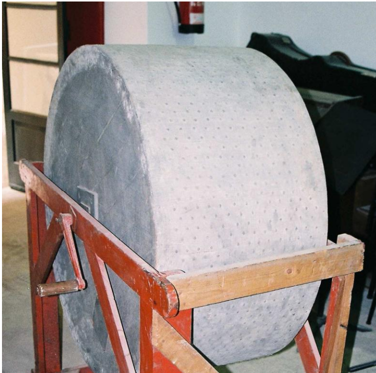
Fig. 317 – Máquina de marear do teatro Nacional S. Carlos (final do século XVIII). Composta por tela, gesso e pregos (e areia por dentro). Caixa de madeira (mais recente) e manivela de metal. Foto do autor.
