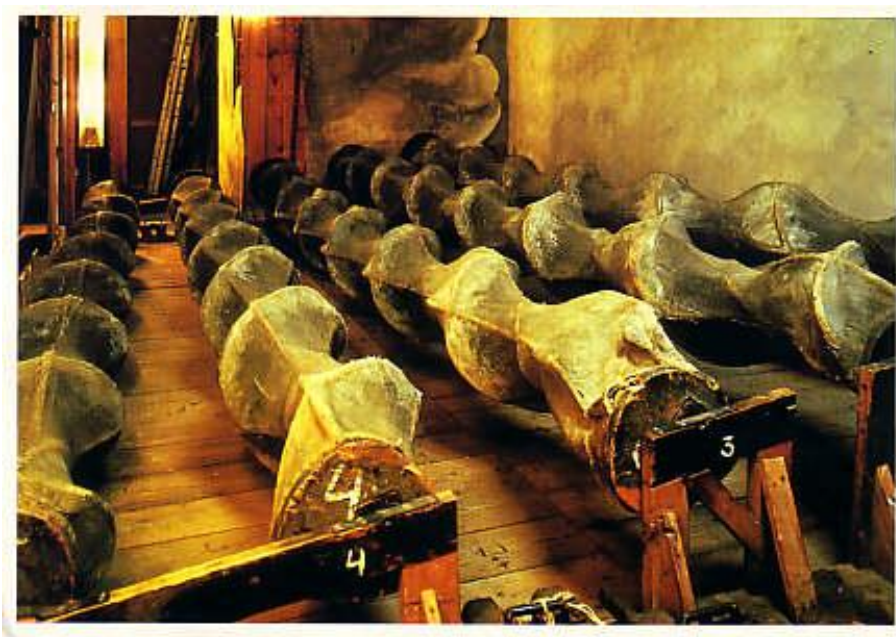
Fig. 309 – Complexo de máquinas de fazer ondas, no teatro de Drottningholm, na Suécia. Original do século XVIII, muito provavelmente semelhantes às usadas em Portugal no mesmo período.
