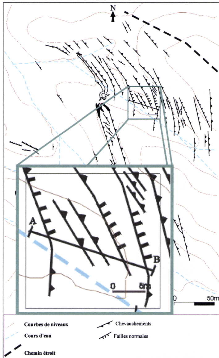
Fig. 11. – Carte montrant les failles normales identifiées dans la région d'Aït Daoud, avec l'indication de la localisation de la coupe (AB) de la Fig. 12.
