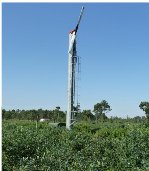
Fig. 1 – Ventilador de protecção contra geadas (Mirtisul).
