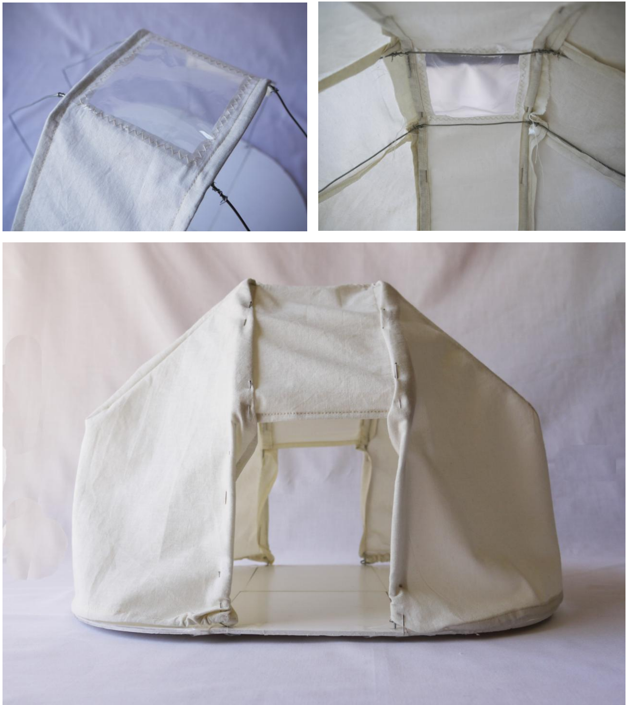
Figura 30 - Maqueta de estudo. Em cima, estudo da estrutura e da claraboia. Em baixo, estudo da tenda tamanho grande.
