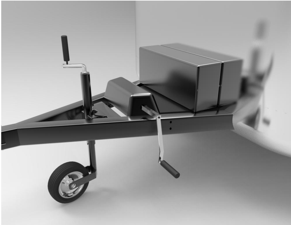
Figura 50 – Sistema de elevação do telhado incorporado no atrelado (ver anexos).
