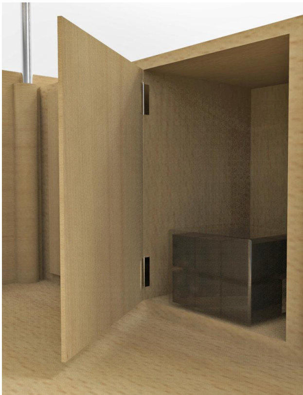
Figura 51 – Espaço para o posicionamento de 12 baterias. 11 baterias mais uma bateria extra (ver anexos).
