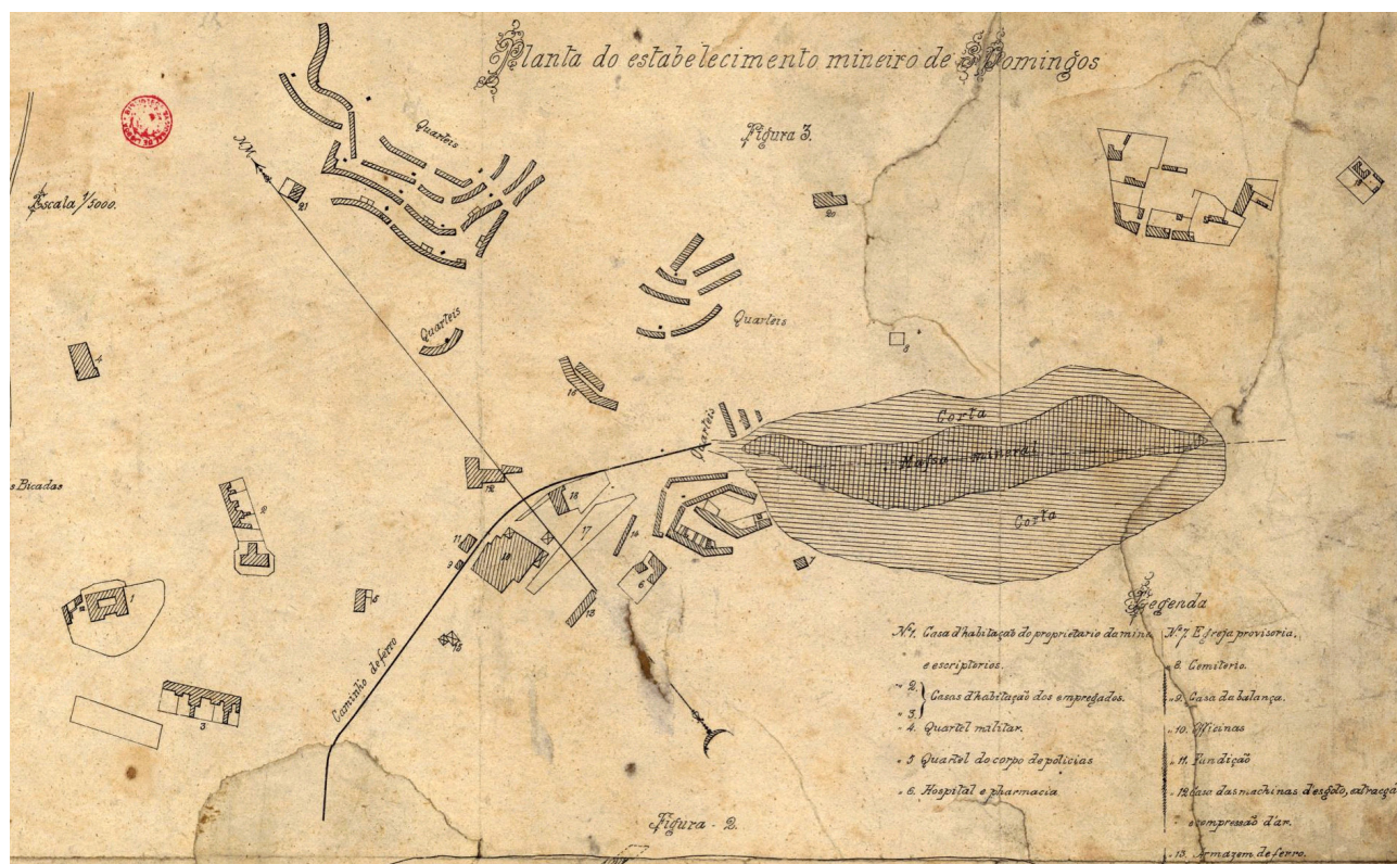
Fig. 3. Pormenor del plano "Planta do estabelecimento mineiro de São Domingos", Revista das Obras Públicas e Minas , 1883. En la leyenda se recogen las piezas objeto de este trabajo con las siguientes numeraciones: 9 Casa da balança, 10 Oficinas, 11 Fundição, 13 Almacém de ferro.
