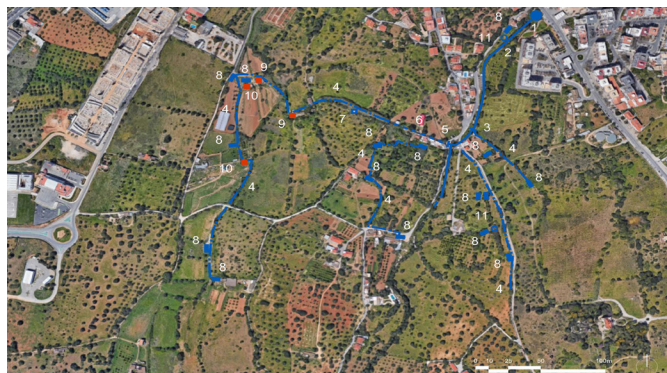
Figura 2. Sistema de regadio e de moenda tradicional em Cadouço / Parrela, a sul de Loulé: 1 – nascente; 2 – linha de água reconstruída; 3 – açude; 4 – acequia/levada; 5 – comporta; 6 – canha; 7 – reservatório; 8 – tanque; 9 – moinho com reservatório; 10 – moinho; 11 – nora.
