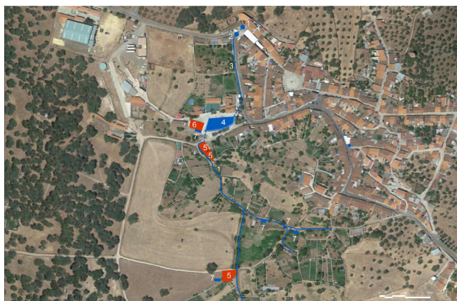
Figura 5. Sistema de regadio e de moenda tradicional em Cañaveral de León: 1. nascente/poço; 2. fonte; 3. acequia; 4. tanque público/laguna; 5. moinho; 6. lagar; 7. tanque
