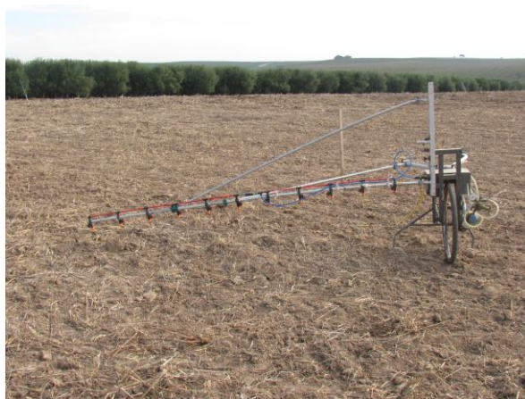
Fig. 2. Pulverizador de pressão de jato projetado para ensaios
