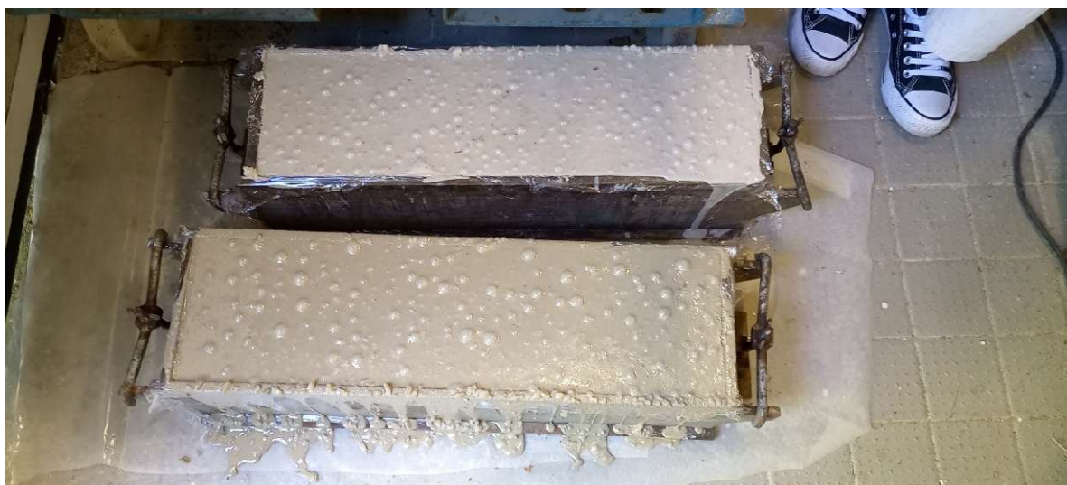
Figura 7 – Formulações em moldes paralelepípedicos.
