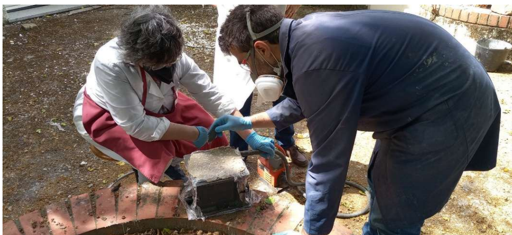
Figura 5 – Vibração do molde metálico preenchido com o compósito, para a remoção de bolhas de ar.
