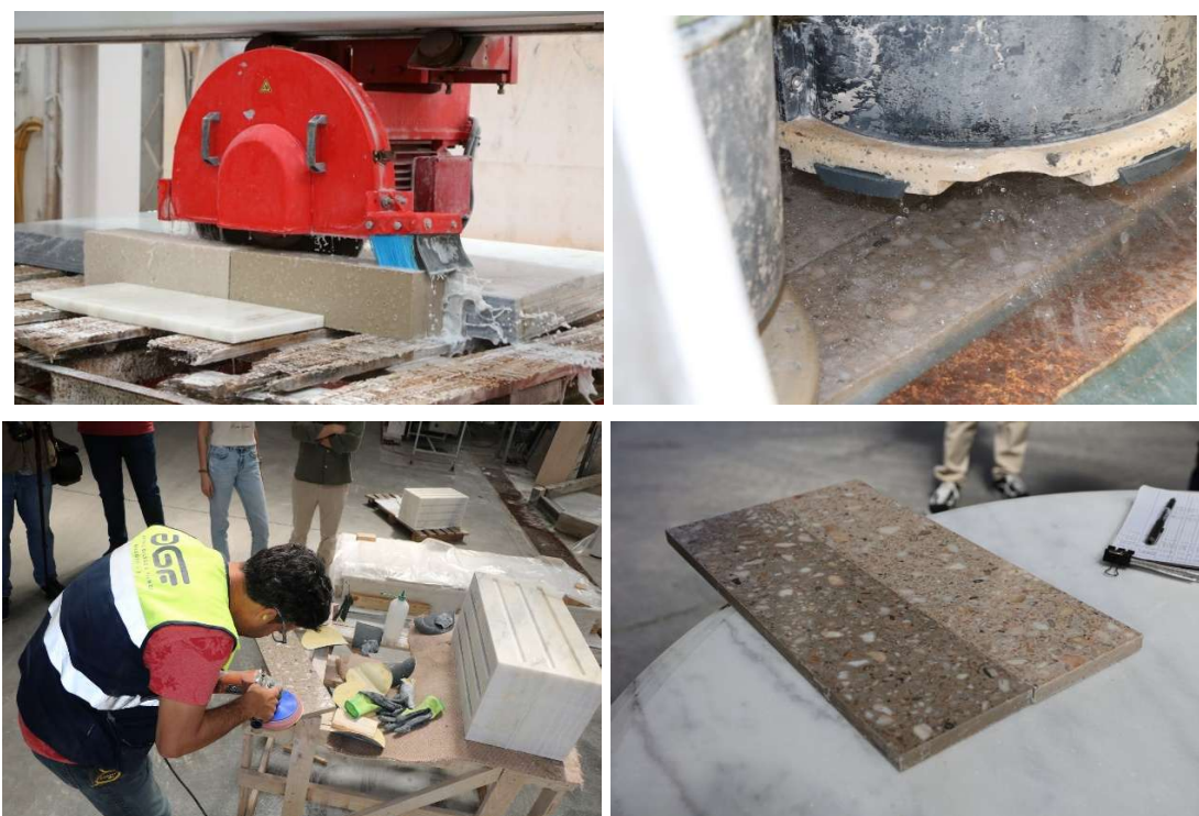
Figura 8 – Processamento dos compósitos na Empresa António Galego & Filhos, Lda.
