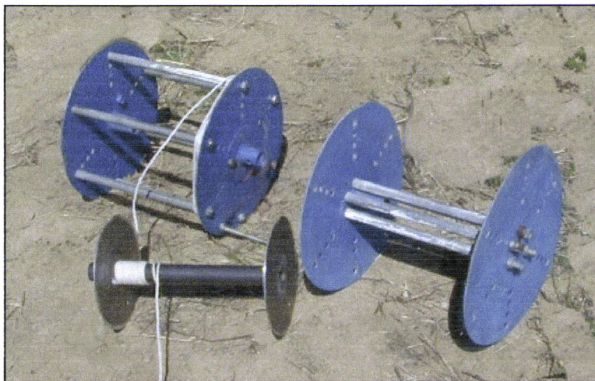
Figura 5.4 A bobine convencional com o diâmetro máximo e mínimo e a nova bobine de diâmetro reduzido.
