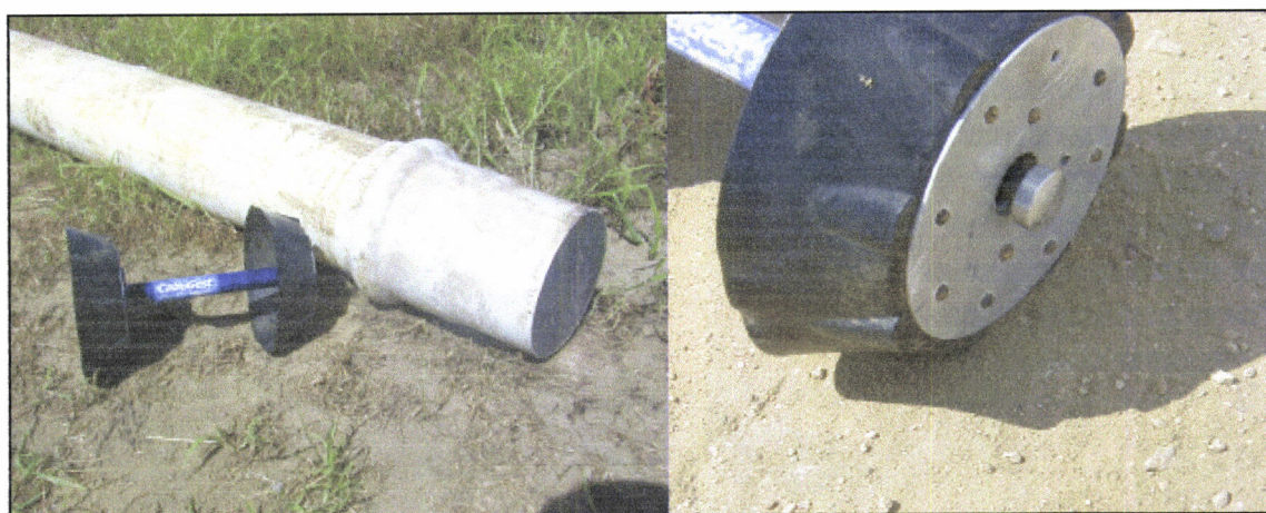
Figura 5.7 Tampão colocado no fim do tubo de cabo-rega, e pormenor do êmbolo auto-solta, mostrando o batente que liberta o cabo.
