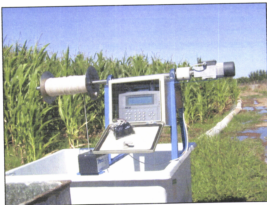
Figura 5.10 Sistema CaboGest solar baseado num programador Cipherlab 520, a funcionar na Estação Experimental da Comenda, Elvas.
