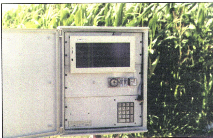
Figura 5.1 O controlador CaboGest em 1999, mostrando a écran LCD e o teclado numérico montados na face interna da caixa.
