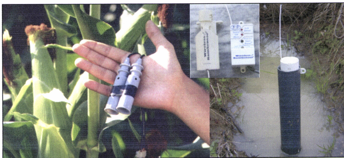
Figura 5.6 Esquerda: Detectores de avanço funcionando com relés RFA. Centro: Emissor e receptor do avanço R&D. Direita: Sensor de avanço sem fios.
