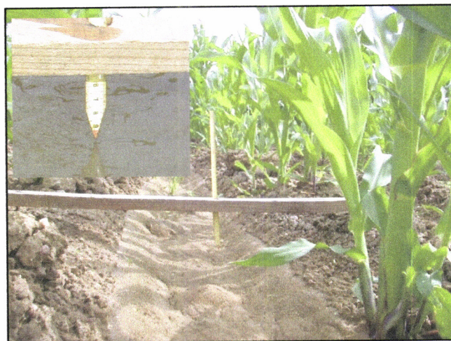
Figura 3.4 Régua deslizante utilizada na medição da profundidade de escoamento. No canto superior esquerdo pode-se ver a ponta da régua deslizante.
