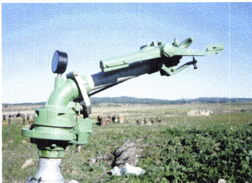
Fig. 3.6. Aspersor Mizar de braço oscilante.
