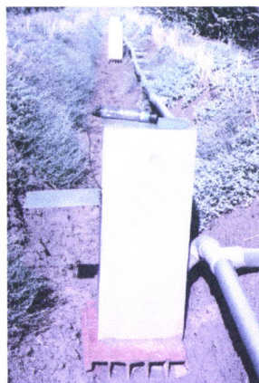
Figura 28 - Canaletes medidores de caudais com sonda de nível de água
