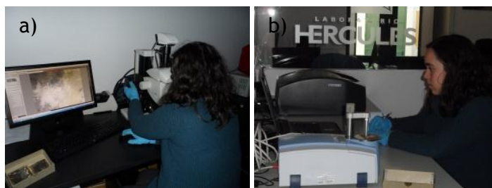
Figura 2: a) observação das amostras por microscopia ótica; b) análise por espectroscopia de infravermelho com módulo ATR.
