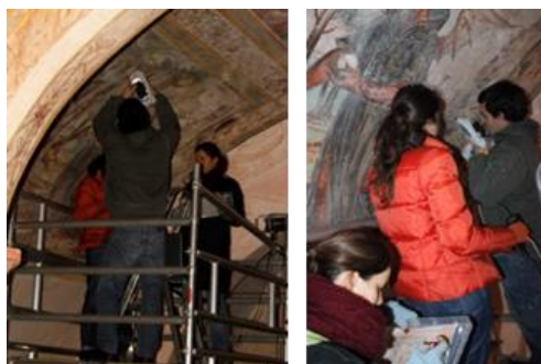
Figura 10: Análise in-situ de fluorescência de raios X.
