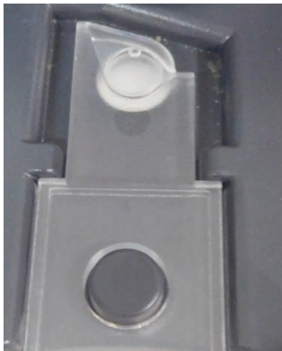
Figura 28: Enchimento incorreto da cuvete de medição com presença de bolha de ar que altera a leitura no espectrofotômetro.
