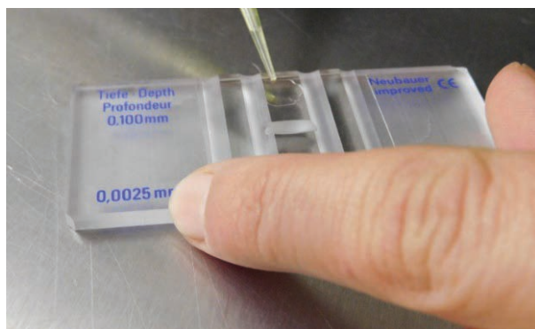
Figura 29: Enchimento por capilaridade da câmara de Neubauer .
