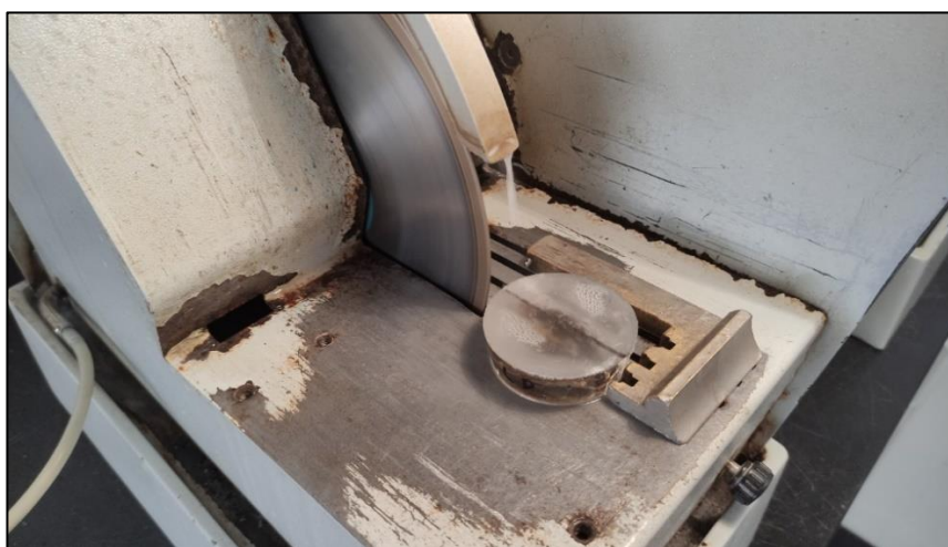
Figura 12. Corte do dente impregnado em epóxi com recurso à Discoplan-TS da Struers. Laboratórios do Departamento de Geociências, Universidade de Évora.
