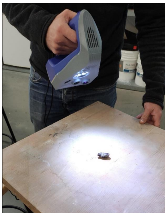
Figura 7. Digitalização através do Scanner 3D Artec Space Spider. Arteria_Lab, Universidade de Évora.
