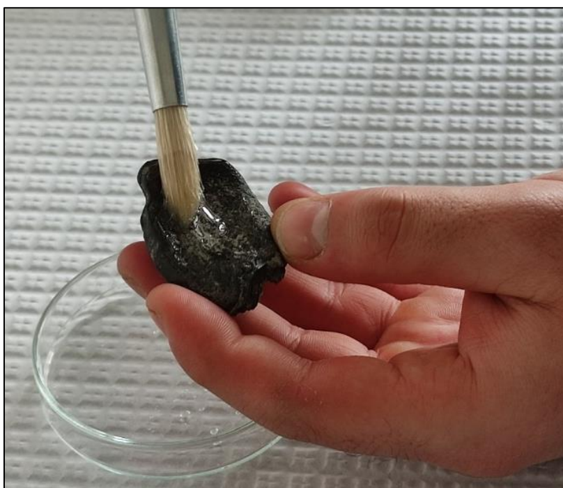
Figura 9. Amostra SHN139 a ser pincelada com vaselina líquida.
