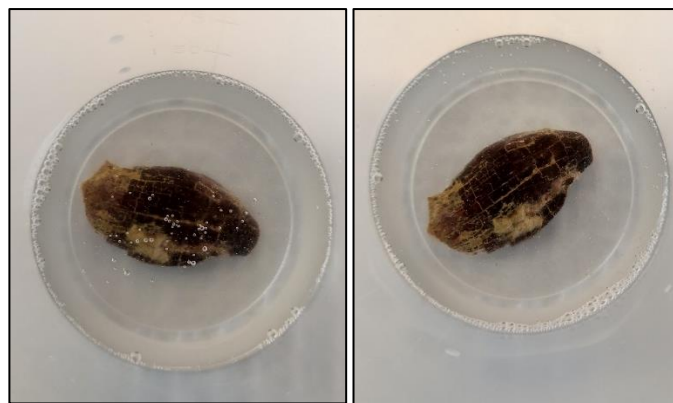
Figura 11. (Esquerda) formação de bolhas durante a impregnação da amostra SBB14 em epóxi; (direita) a amostra com as bolhas controladas.
