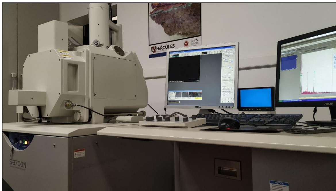
Figura 16. Microscópio eletrónico de varrimento HITACHI™ S3700N acoplado a um detetor de espectroscopia de energia dispersiva de raios-X Bruker™ Xflash 5010 SDD. Laboratório HERCULES, Uni. de Évora.
