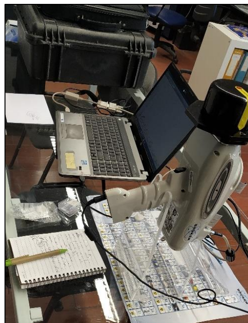
Figura 15. Método de trabalho com o sistema de fluorescência de raios-X portátil Bruker™ Tracer III SD®. Laboratório HERCULES, Universidade de Évora.
