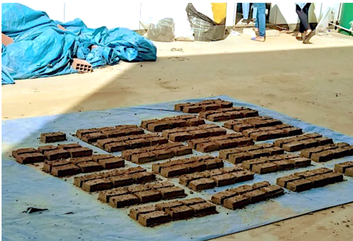
Figure 4.23. Briques de terres séchées au soleil. Photographie DKC, mai 2019.
