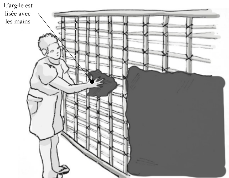
Figure 1.7. Représentation de l'ajout de l'argile de la "taipa de mão" selon Weimer.
