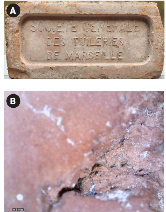
FIGURA 5 | Tijolo cerâmico com a presença de sais solúveis e fissuras: a) imagem de tijolo do Pavilhão Mourisco. b) Ampliação mostrando detalhe de fissuras e a presença de sais no material. FONTE: AUTORES (2024).
