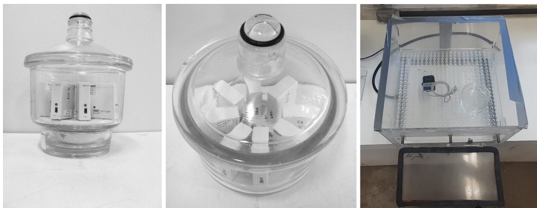
FIGURA 2 | Montagem experimental para aferição, em laboratório, de registradores de umidade relativa – (a) e (b): dessecador; (c) câmara microclimática com vedação.
